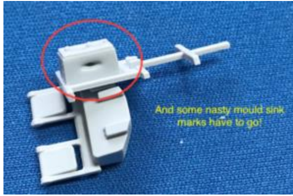
SINK MARK ÇÖKME İZİ
